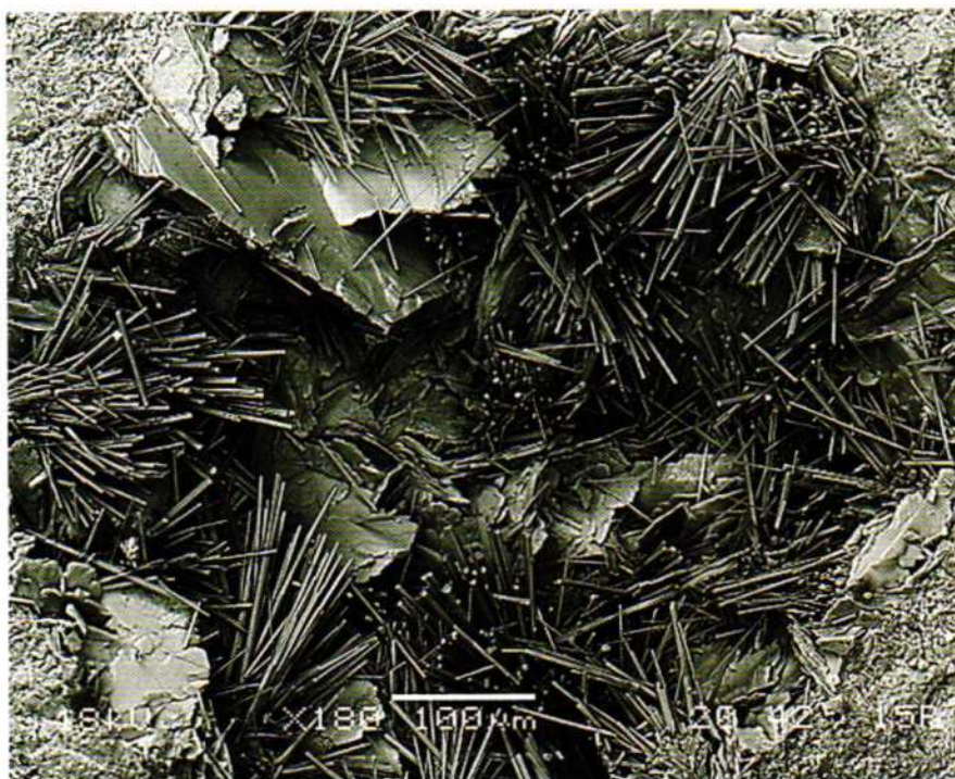
Immagine SEM di un gruppo di cristalli aciculari di ettringite in una bollosità del cemento di Feriolo. Coll. MSNM inv. M36298, foto A. Guastoni.
