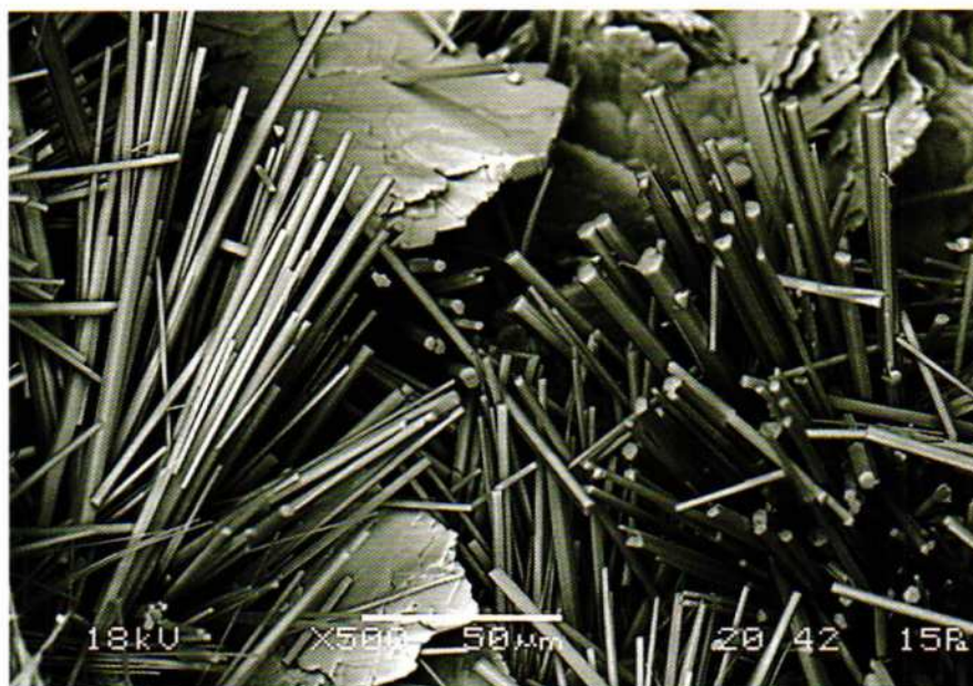
Particolare dell'immagine precedente di cristalli ettringite in una bollosità del cemento di Feriolo. Coll. MSNM inv. M36298, foto A. Guastoni.
